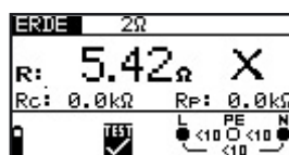
Abb. 5.46: Beispiel eines Ergebnisses der Erdungswiderstandmessung
